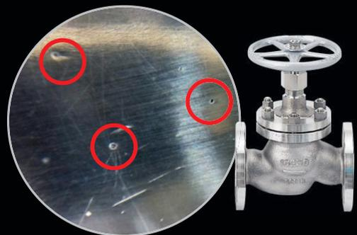
**CASTING INNER SURFACE SHRINKAGE PIN HOLES**
